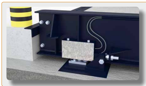
■ Las células quedan protegidas de la intemperie mediante una chapa galvanizada.
