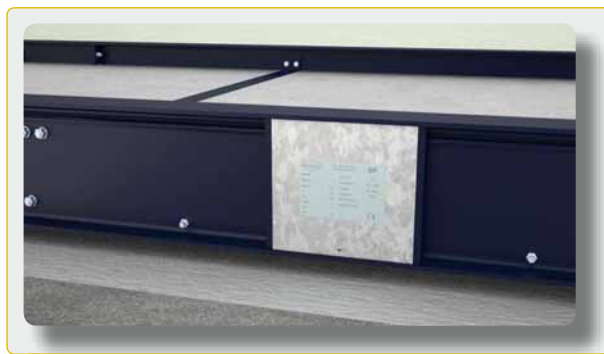
■ Tapa de armario montada con placa de características anclada mediante tornillos.
